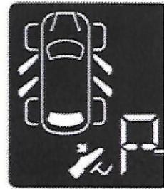
Das Fahrzeug kann nur gestartet werden, wenn das Ladekabel nicht mehr am Fahrzeug angeschlossen ist und der Schalthebel auf P steht.
